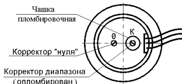
Рисунок 13 – Схемы верхней платы и элементов регулировок датчиков моделей 7XXX и 8XXX
