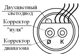
Рисунок 13 – Схемы верхней платы и элементов регулировок датчиков моделей 7XXX и 8XXX
