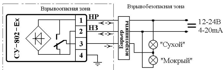
СУ взрывозащищенного Ex исполнения с барьером искрозащиты
