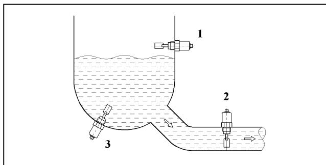
СУ может быть установлен в любом положении на дне или стенках резервуара и трубопровода.
