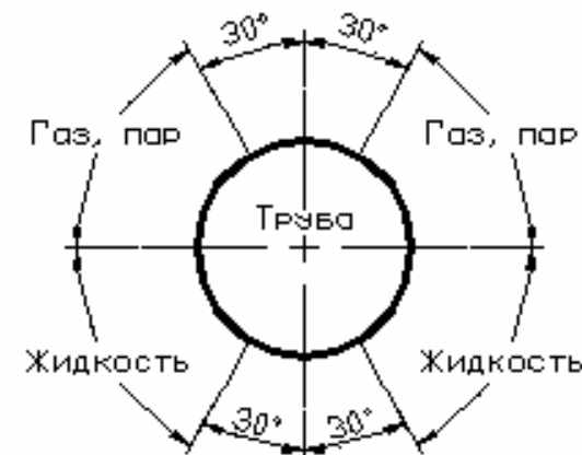
Рисунок Д.1 – Места отбора давления - зоны приварки соединительных трубок для различных рабочих сред
